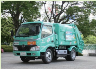
平成15年から提唱し、平成20年に実現、現在稼働しているハイプレットごみ収集車
